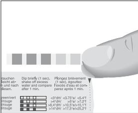
Vous pouvez déterminer la dureté de l'eau à l'aide de la languette de test Aquadur® fournie.
