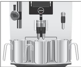
**i** Vous pouvez interrompre à tout moment le rinçage du filtre en appuyant sur une touche quelconque. Appuyez sur le Rotary Switch
